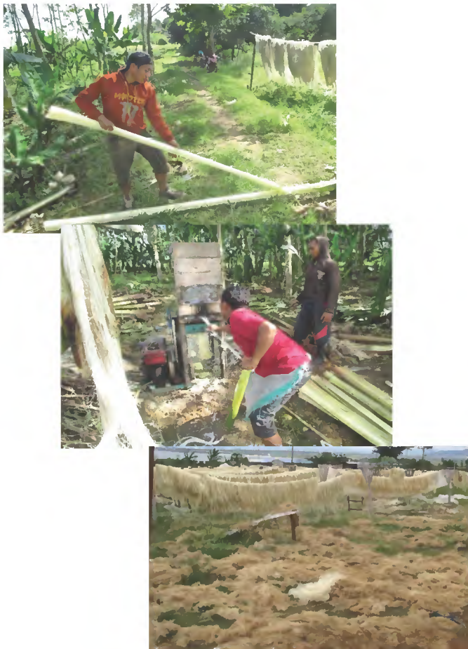
Gambar 1. Proses pemisahan pelepah dan penyeratan abaca dengan dekortikator
