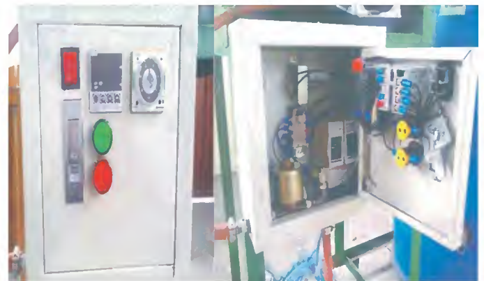
Gambar 3. Panel kontrol HWT saat ditutup (kiri) dan dibuka (kanan)
