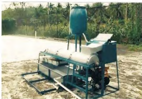
Gambar 3. Alat pengolahan sagu mekanis sistem terpadu
