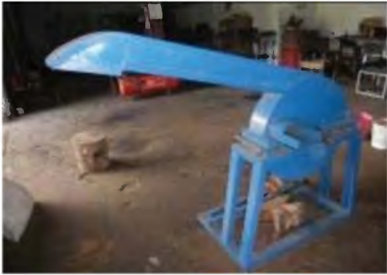
Gambar 4. Pencacah daun/pelepah sagu baruk dan penghancur bahan organik
